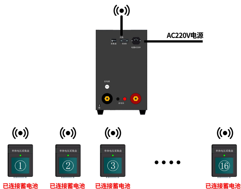
单体监测模块与充放电仪主机、两者之间通讯示意图
